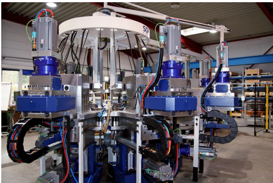
Integrierte Stauchpressen im SPEEDMAX L (Fotoinweis: Schmale Maschinenbau)
