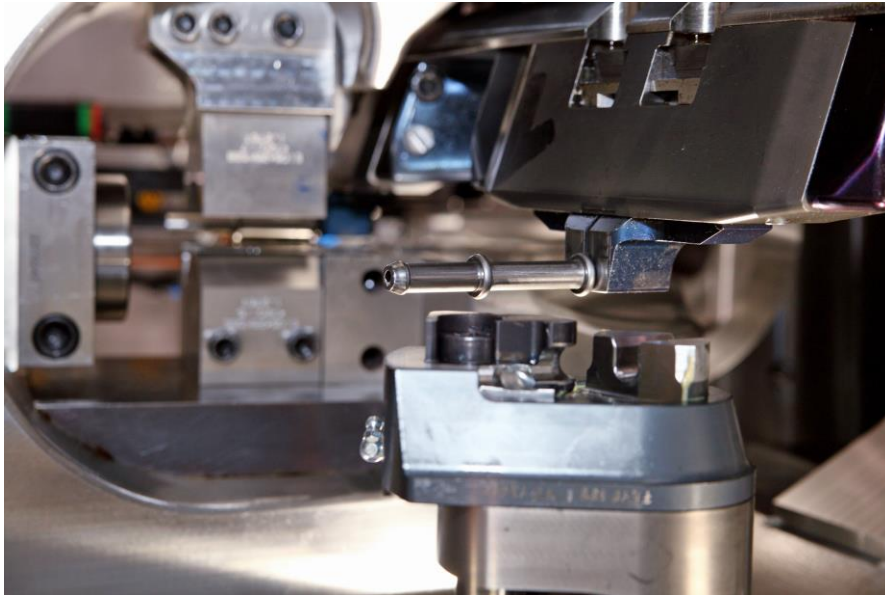
Stauchpressen und Fingerbieger auf dem SPEEDMAX L (Fotoinweis: Schmale Maschinenbau)
